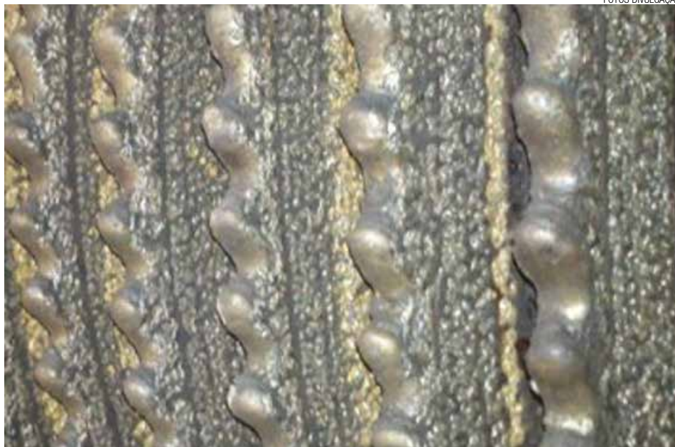
Chapisco realizado com arame tubular: repetibilidade no processo e alta produtividade
